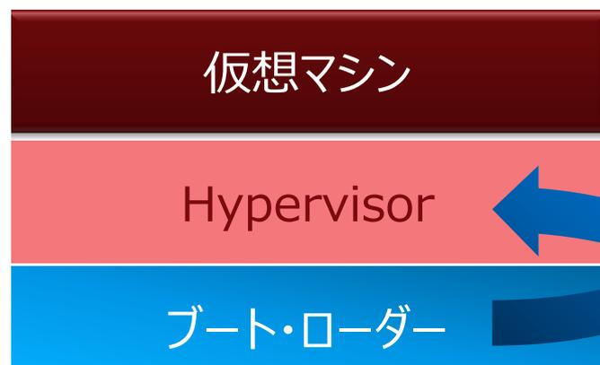
HW内(CPUなど)にvSphere5.1のバイナリファイルから取得したハッシュ値を記憶させ、これからロードするHypervisorの情報とを比較し改変されていれば、起動させないor警告を出力される。
